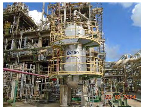
ภาพที่ 2-26 Hydrogenation Drum
